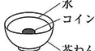
1. コインからの光が水面で屈折し、そのときの屈折角が入射角より小さいため。
